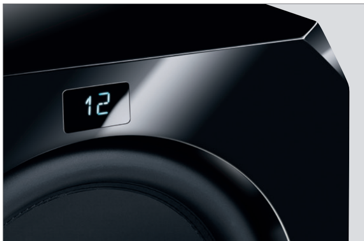
Ein zweistelliges Display kündigt von der aktuell gewählten Lautstärke, das vermeidet Überraschungen
